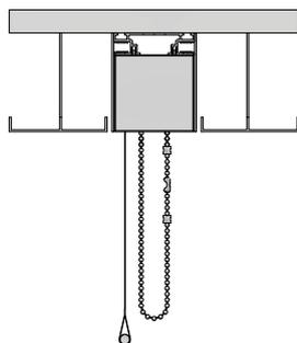
Einbau in abgehängte Decke aus Metall
