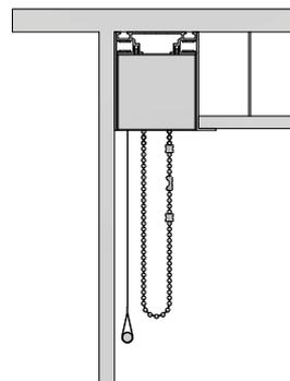
Einbau in abgehängte Decke
