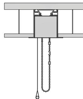
Einbau in abgehängte Decke
